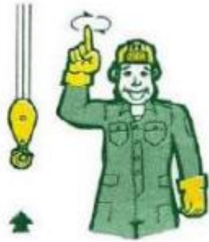
สัญญาณให้ยกของขึ้น-ลงได้ LIFT LOAD
