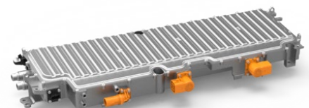
3 in1 unit: 22kW OBC, 3,7kW DCDC, ECU
